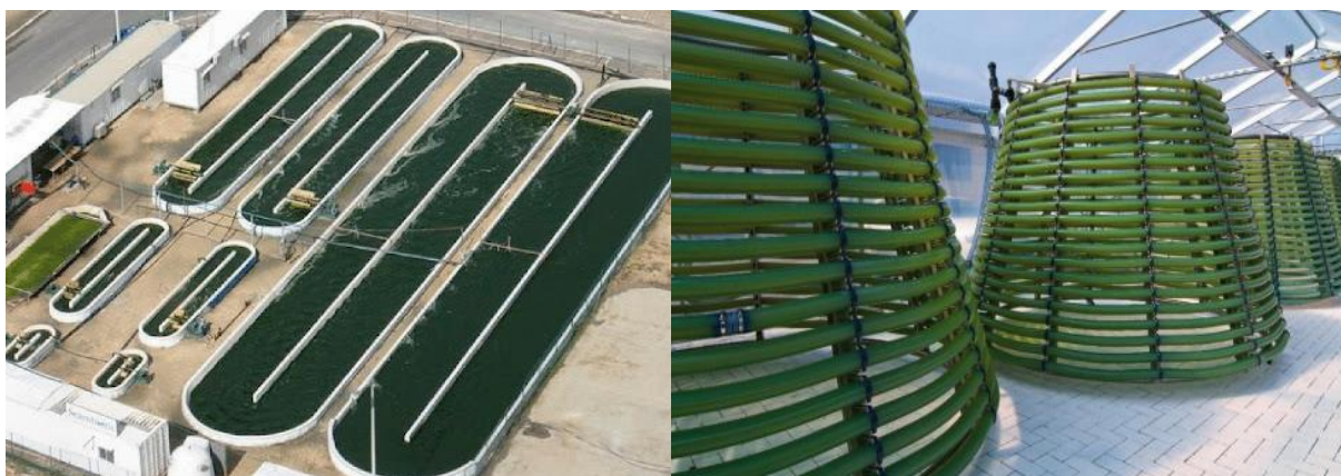
Figura 1 – Sistema de cultivo de microalgas em lagoas abertas do tipo pista de corrida ( raceways ) (a) e fotobiorreatores (b).
