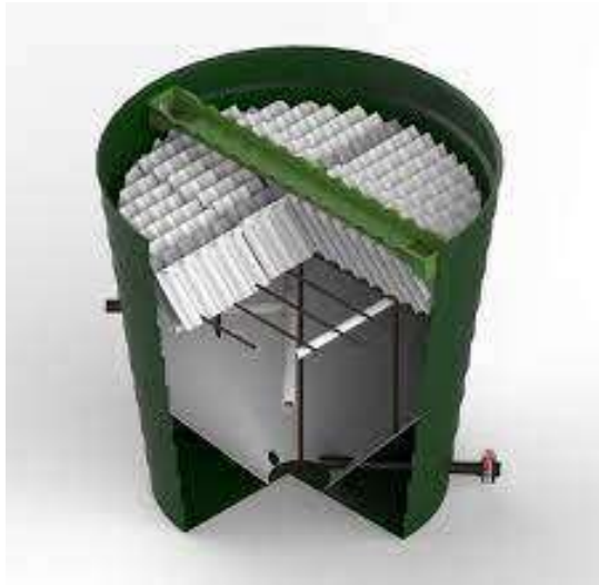
Figura 5.3 - Decantador lamelar de formato tubular e saída em pirâmide invertida
