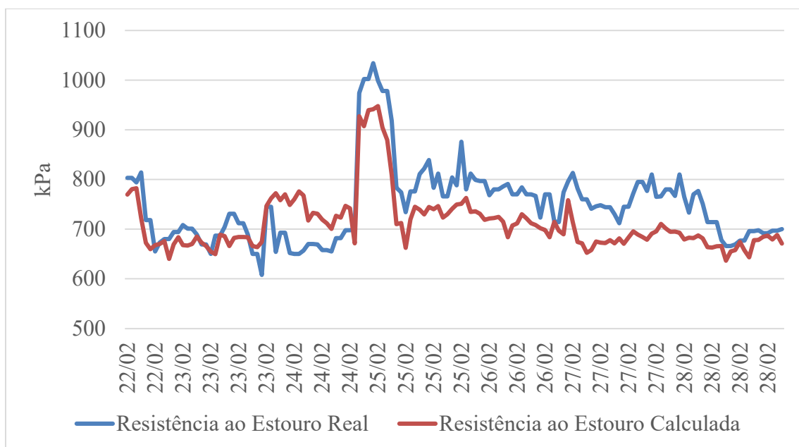
Figura 4 – Resistência ao Estouro real vs calculada obtida no mês de fevereiro de 2021.
