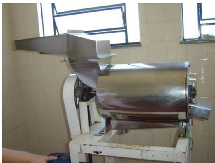
Figura 2: Despulpadora de operação com moinhos de martelos e peneiras em inox
