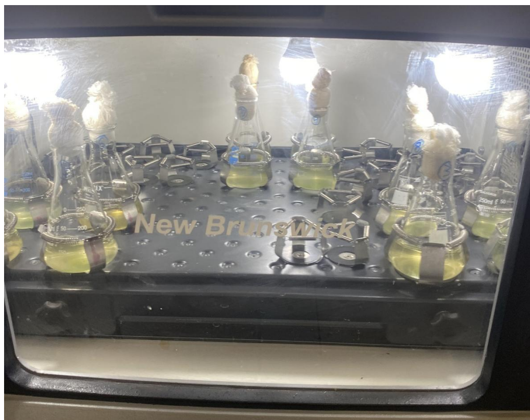
Figura 3 – Cultivo das microalgas C. sorokiniana e Scenedesmus sp. com controle de agitação (150 RPM), temperatura (25°C) e iluminação (1400 lux)
