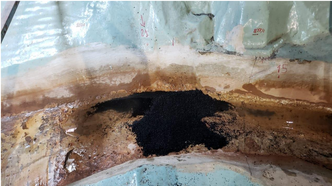
Figura 15 – Assoreamento próximo à seção “21”, seção onde foi inserido o sedimento no modelo reduzido.
