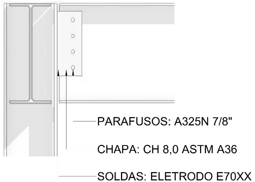
Figura 17 - Ligação Tipo LCHS
