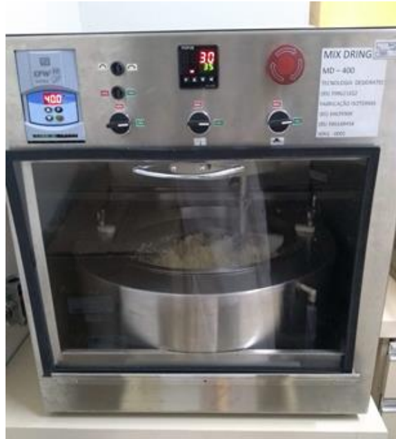
Figura 2: Equipamento contendo B. thuringiensis crescido em substrato de arroz em processo de secagem.
