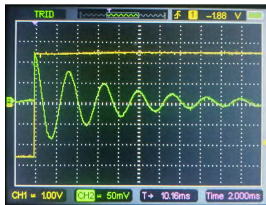
Figura 5 – Resposta esperada do circuito tanque.
