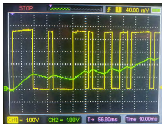
Figura 6 – Resposta de um sistema com o tempo entre cada mudança de estado muito baixo, gerando tendência.
