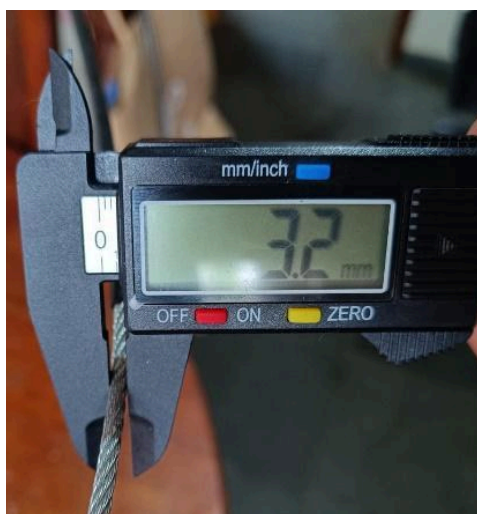
Figura 9 – Cabo utilizado em pulley
