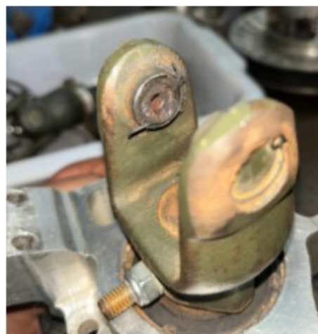
Figura 5 – Falha na Junta Universal OEM.
