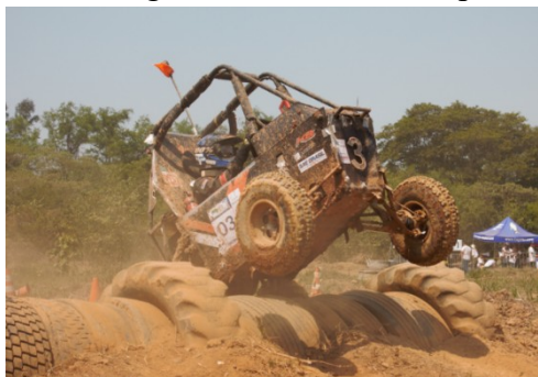
Figura 1 - Protótipo do tipo Mini Baja transpondo obstáculo.
