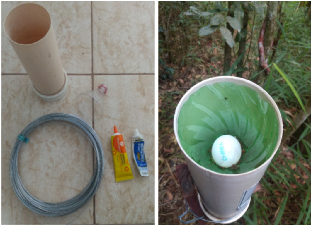
Figura 11: Materiais utilizados para confecção do pluviômetro artesanal (à direita) e pluviômetro montado em campo, com destaque para a parte superior do recipiente (à esquerda).
