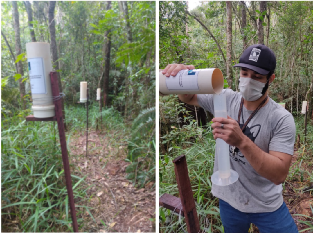
Figura 12: à direita (a), detalhe dos pluviômetros artesanais perfilados sob o dossel florestal. À esquerda (b), mensuração dos fluxos em campo.
