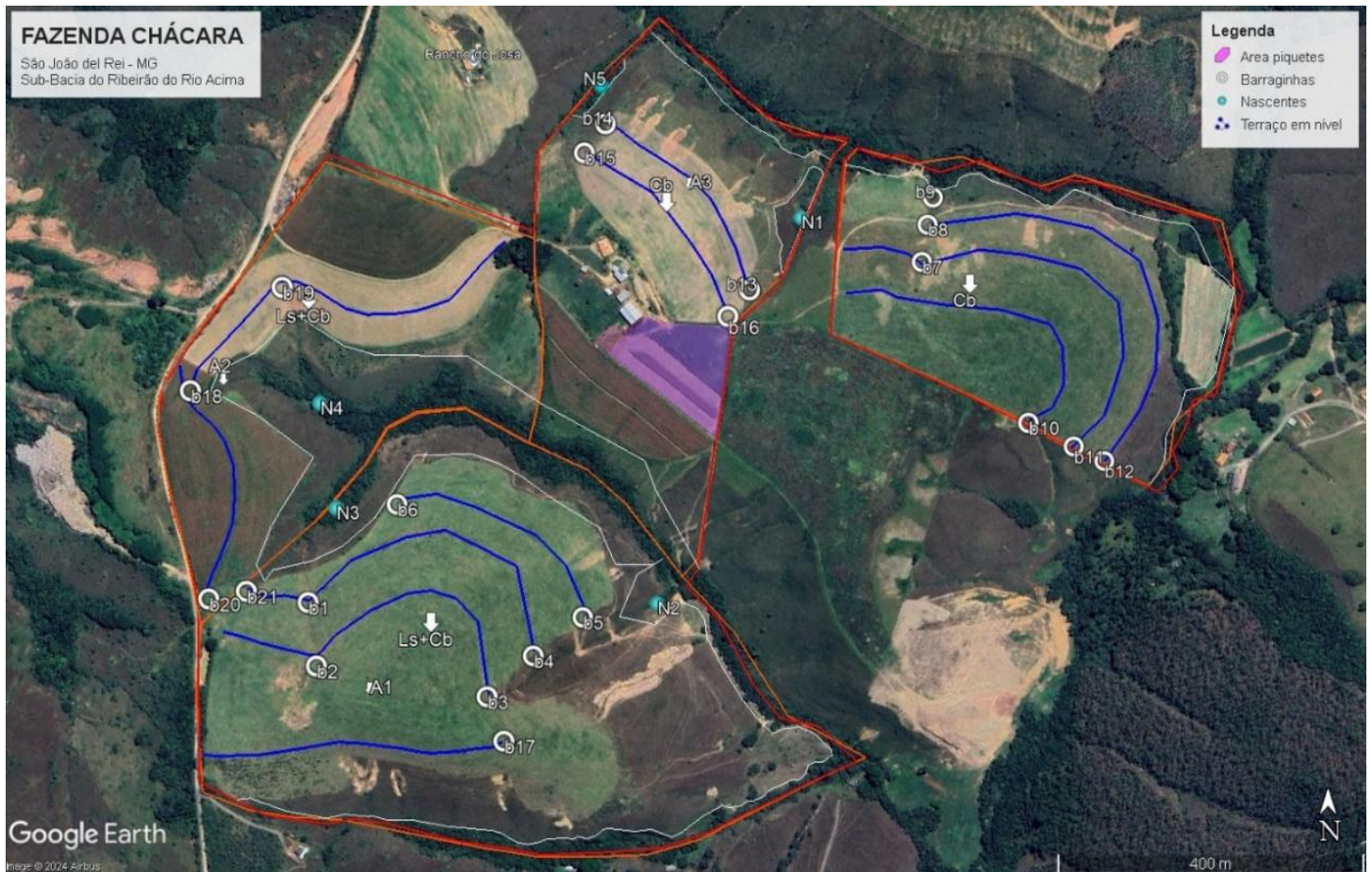
Figura 9- Planejamento das intervenções conservacionistas na propriedade modelo, incluindo curvas de nível (azul), bacias de captação (círculos), área destinada ao pastejo rotacionado (roxo), delimitação da propriedade (vermelho) e APPs destinadas ao cercamento e restauração da vegetação nativa (branco).
