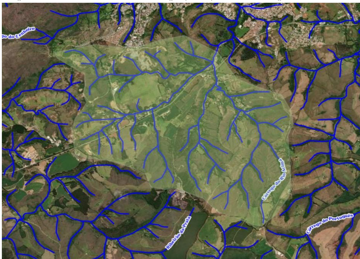
Figura 2 –Delimitação da bacia do Córrego do Rio Acima e sua rede de drenagem, localizada na região do Morro Grande, zona rural de São João del-Rei, MG. O contorno destacado representa o limite da microbacia hidrográfica, e as linhas azuis indicam os cursos d'água que compõem sua rede hidrográfica.
