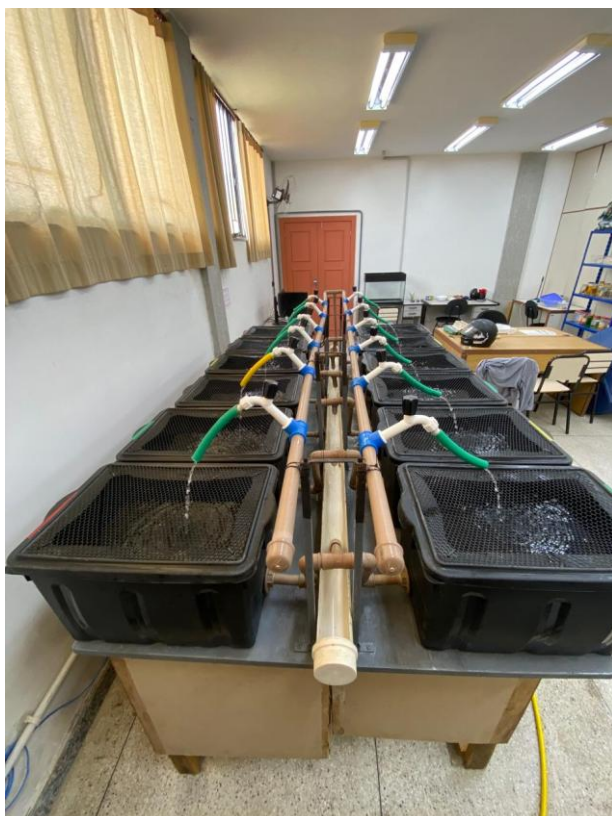
Figura 3 – Sistema de recirculação de água (RAS), contendo doze caixas de polipropileno de 40 litros de volume útil. Vista frontal Foto: Acervo pessoal
