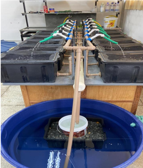
Figura 5 – Sistema de recirculação de água (RAS). Vista frontal dos filtros biológico e mecânico para nitrificação da água. Foto: Acervo pessoal
