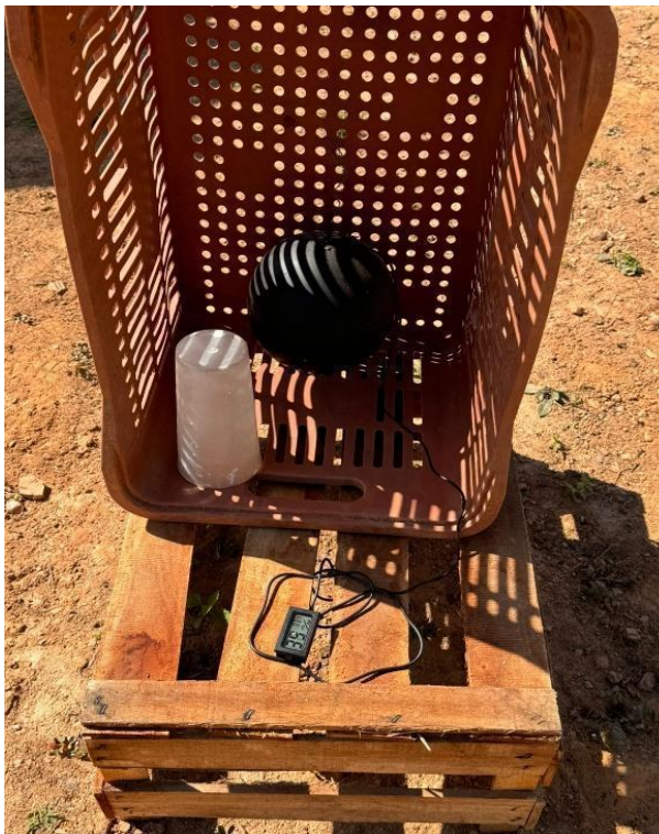
Figura 15 – Termo-higrômetro digital com sensor em globo negro posicionado na área externa dos protótipos, no centro do campo experimental.
