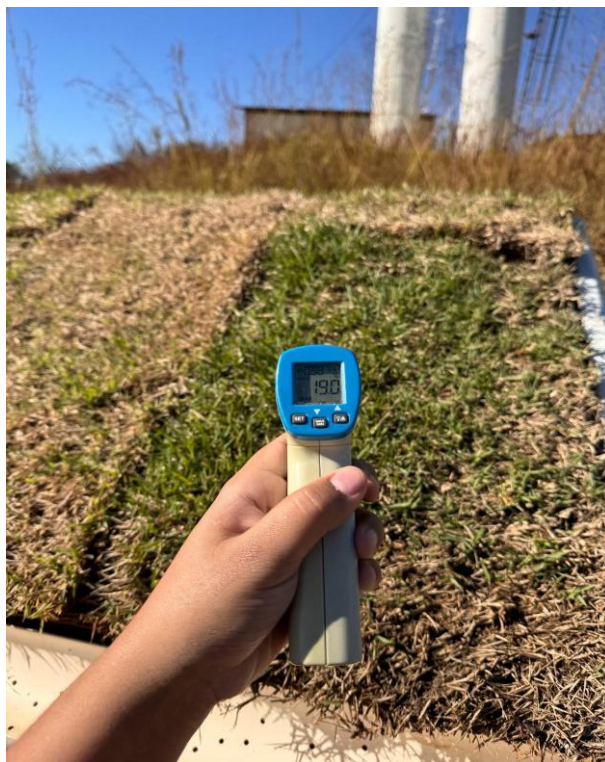
Figura 10 - Termômetro infravermelho utilizado nas medições de temperatura dos telhados.
