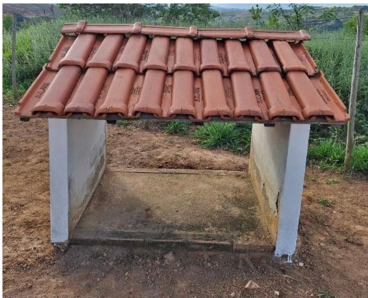
Figura 7 – Telhado cerâmico do tipo colonial utilizado no experimento.
