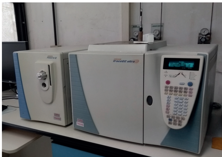
Figura 6. Cromatógrafo a gás Trace GC Ultra ( Thermo Scientific, San Jose, CA ) acoplado a espectrômetro de massas Polaris Q ( Thermo Scientific, San Jose, CA ).
