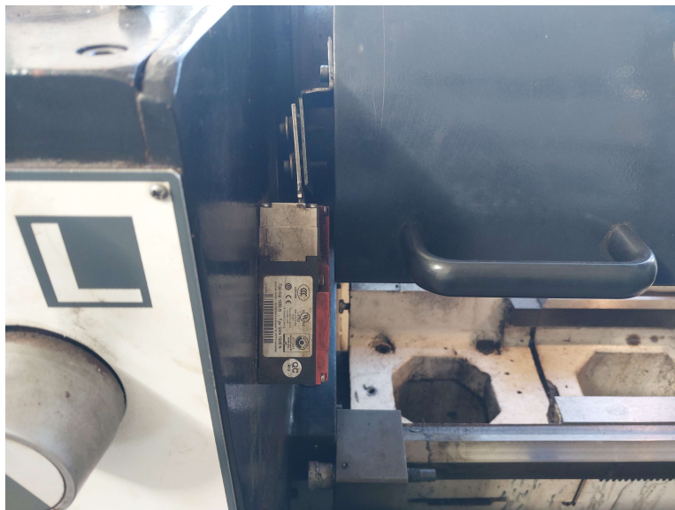
Fig 2. Sensor da proteção das castanhas (Fonte: Autoral)
