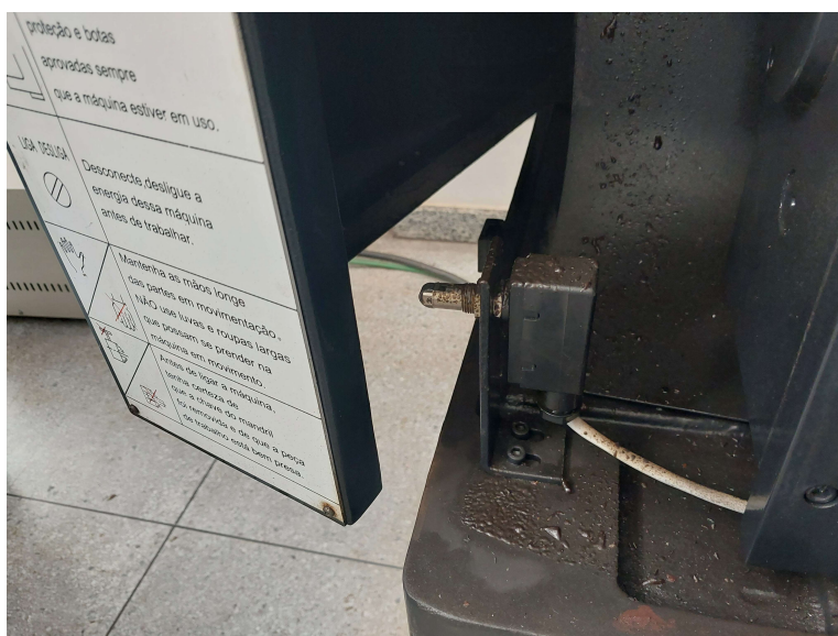
Fig 4. Sensor da proteção do conjunto de engrenagens (Fonte: Autoral)
