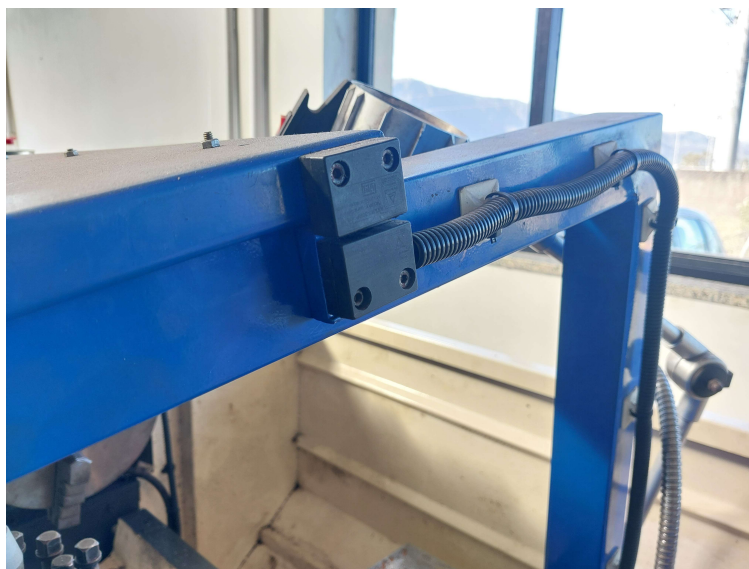
Fig 3. Sensor da proteção do carro principal (Fonte: Autoral)
