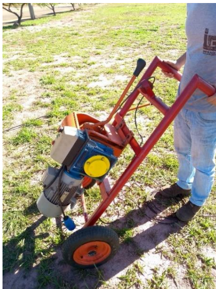
Figura 33 - Acoplamento do motor elétrico desenvolvido
