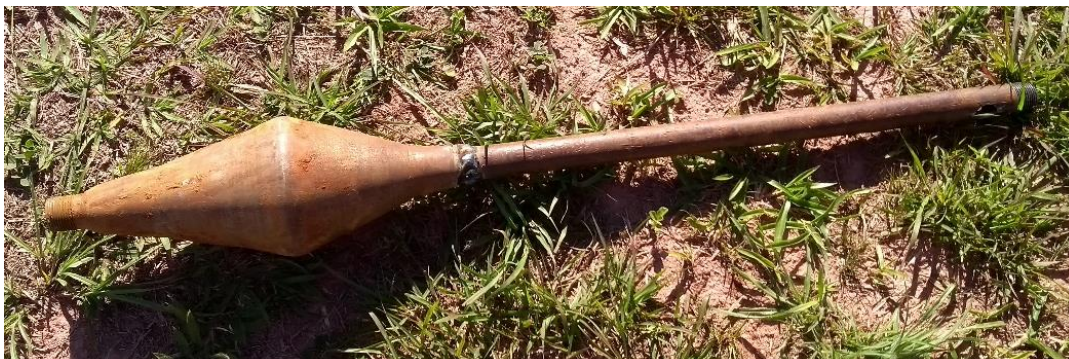
Figura 26 - Bulbo metálico soldado a haste do SPT
