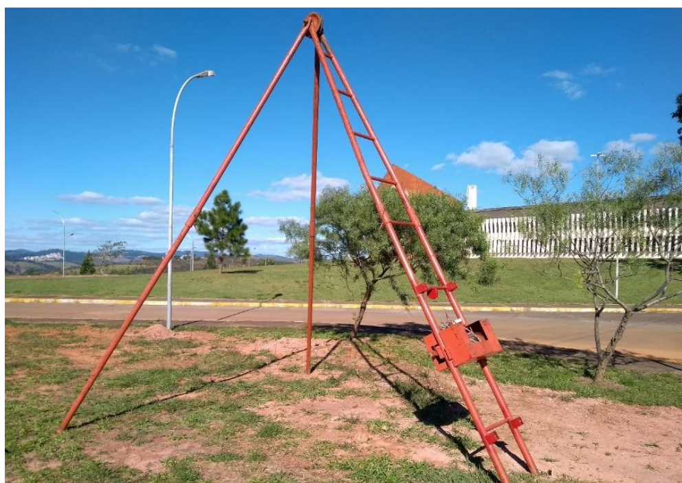
Figura 32 - Equipamento de execução do SPT
