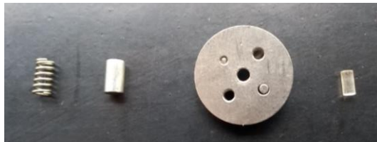
Figura 11 - Peças internas da lâmina dilatométrica
