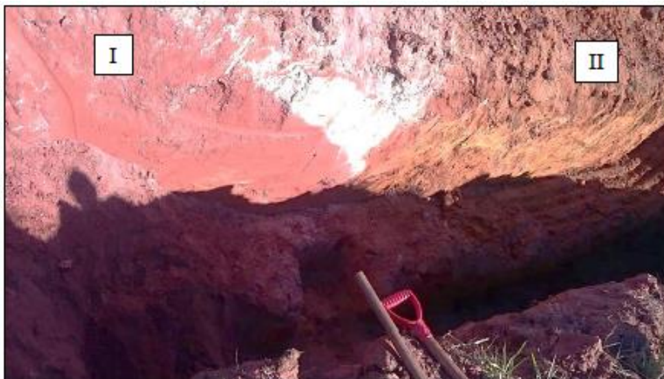
Figura 4 - Trincheira apresentando variação do tipo de solo
