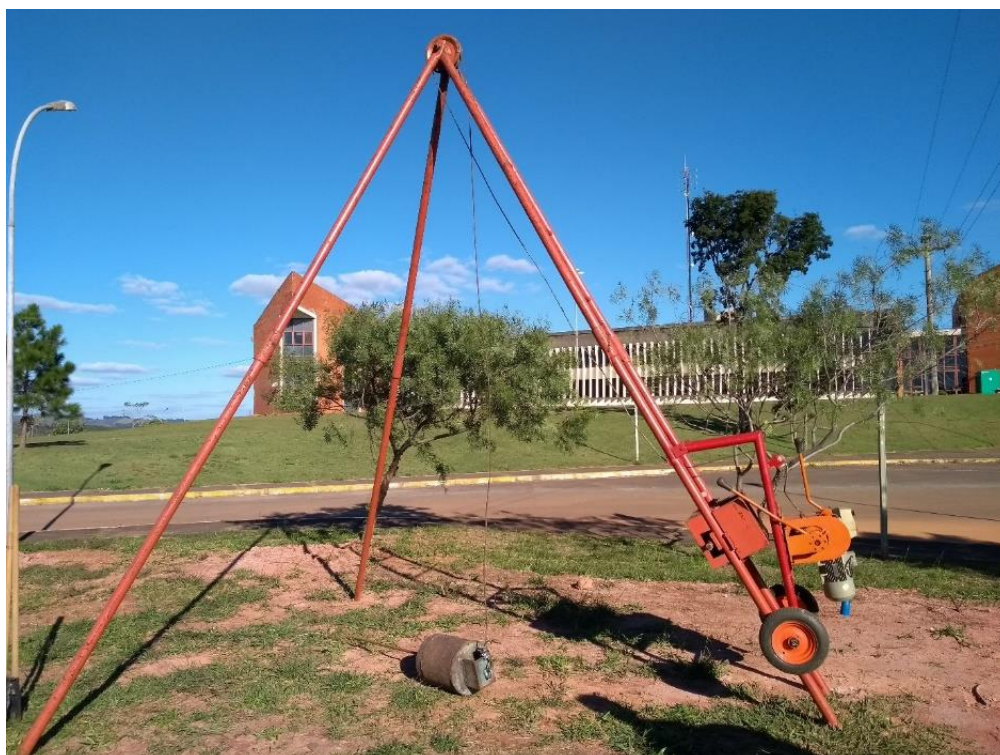
Figura 34 - Equipamento SPT com motor elétrico
