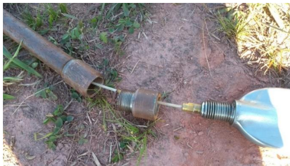
Figura 31 - Adaptador da lâmina dilatométrica para o SPT
