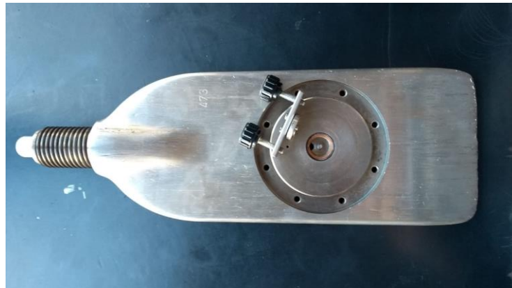
Figura 10 - Interior da lâmina dilatométrica
