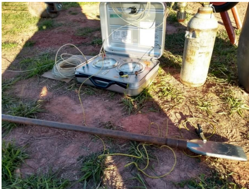
Figura 5 - Equipamento do DMT pronto para ensaio
