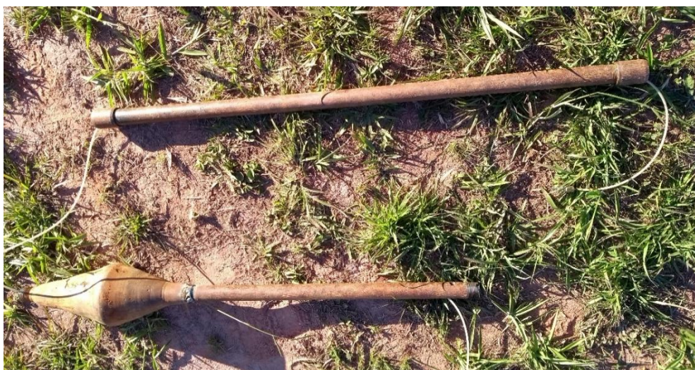
Figura 30 - Haste perfurada e bulbo metálico montados para ensaio
