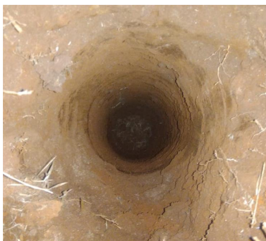
Figura 28 - Abertura no solo proporcionada pelo bulbo metálico
