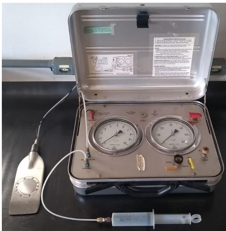
Figura 24 - Calibração da membrana
