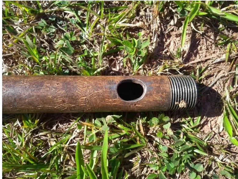
Figura 29 - Furo na haste metálica
