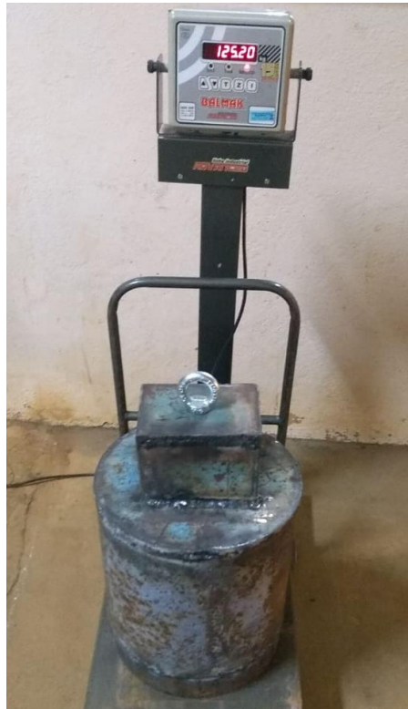
Figura 35 - Pesagem do martelo de 125 kg
