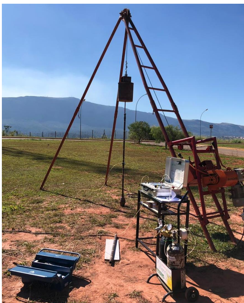
Figura 37 - Execução do ensaio DMT
