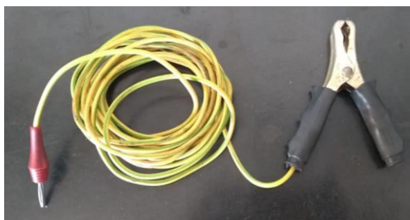
Figura 19 - Cabo de aterramento
