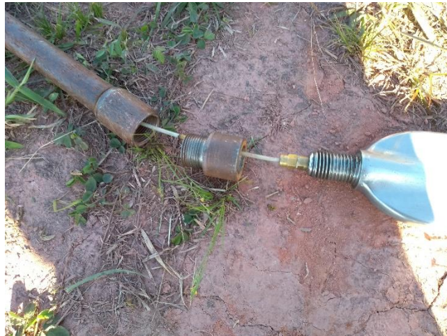
Figura 15 - Adaptador para unir lâmina e hastes do SPT
