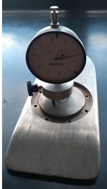
Figura 12 - Calibração do disco sensitivo
