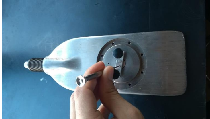
Figura 9 - Remoção do disco sensitivo
