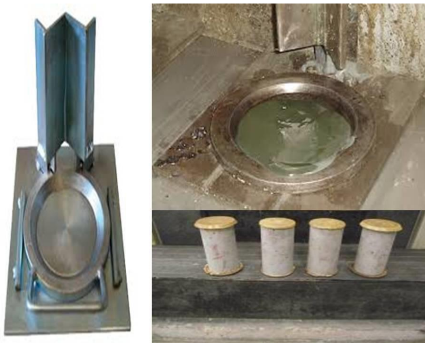
Figura 4 - Procedimento de preparação do corpo de prova (capeamento)
