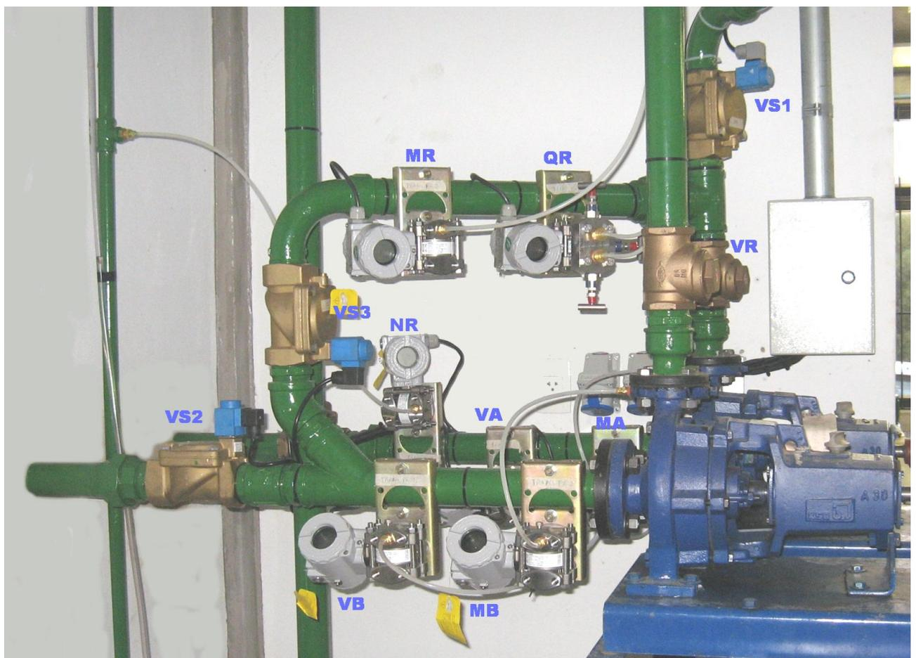
**Figura 4. Detalhes da instrumentação da Bancada de Bombas**
