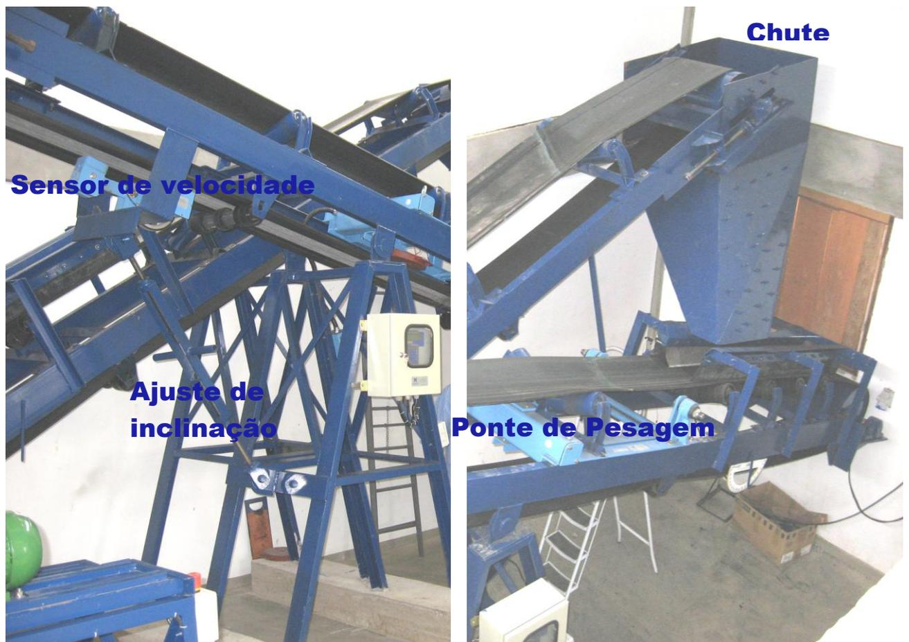
Figura 9. Detalhes dos equipamentos do Sistema Fechado de Correias Transportadoras
