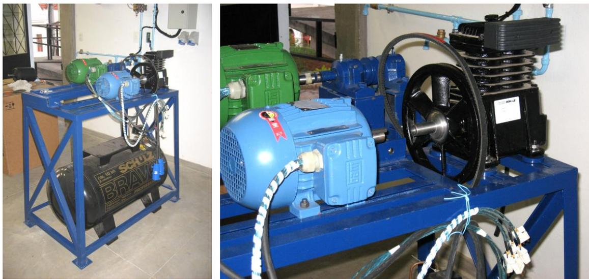
Figura 17. Detalhes da montagem do compressor de pistão
