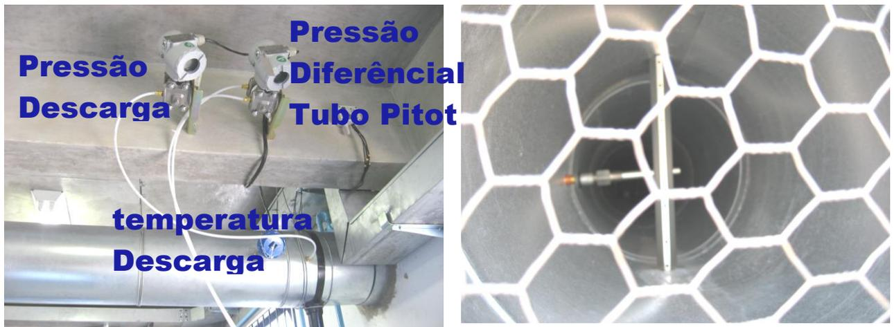
Figura 14. Detalhes da montagem da bancada do ventilador com vista do sensor de temperatura e a haste do tubo Pitot no interior da tubulação de descarga
