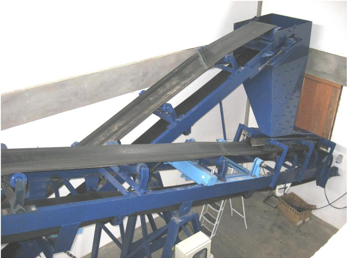
**Figura 8. Vista do Sistema Fechado de Correias Transportadoras**
