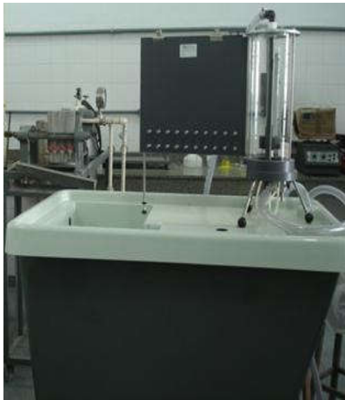
Fig.3: Bancada Trajetória de Jato e escoamento através de um orifício
