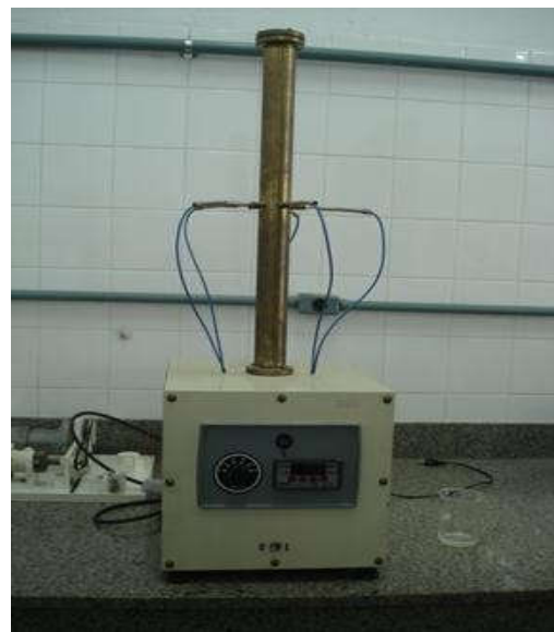
Fig.8: Bancada Condutividade Térmica
