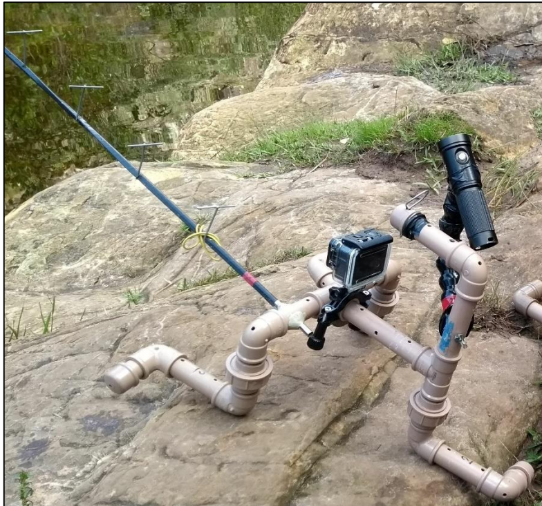
Figura 4 Estrutura de pvc da BRUV, com haste para suporte de isca, câmera de filmagem subaquática e lanterna.
