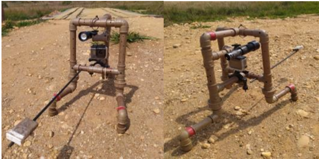
Figura 4 - Estrutura da estação remota de vídeo (BRUV).
