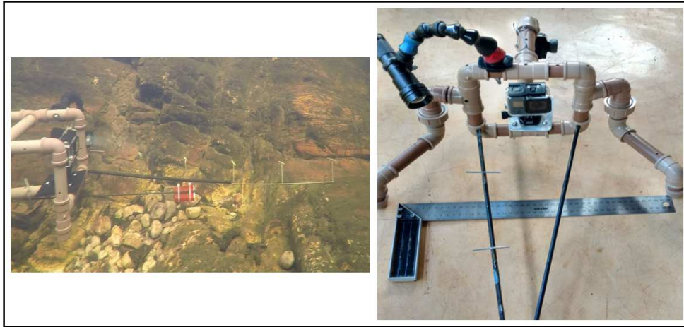
Figura 8 - Imagem da estrutura que compõe a BRUV utilizada para o levantamento dos dados.
