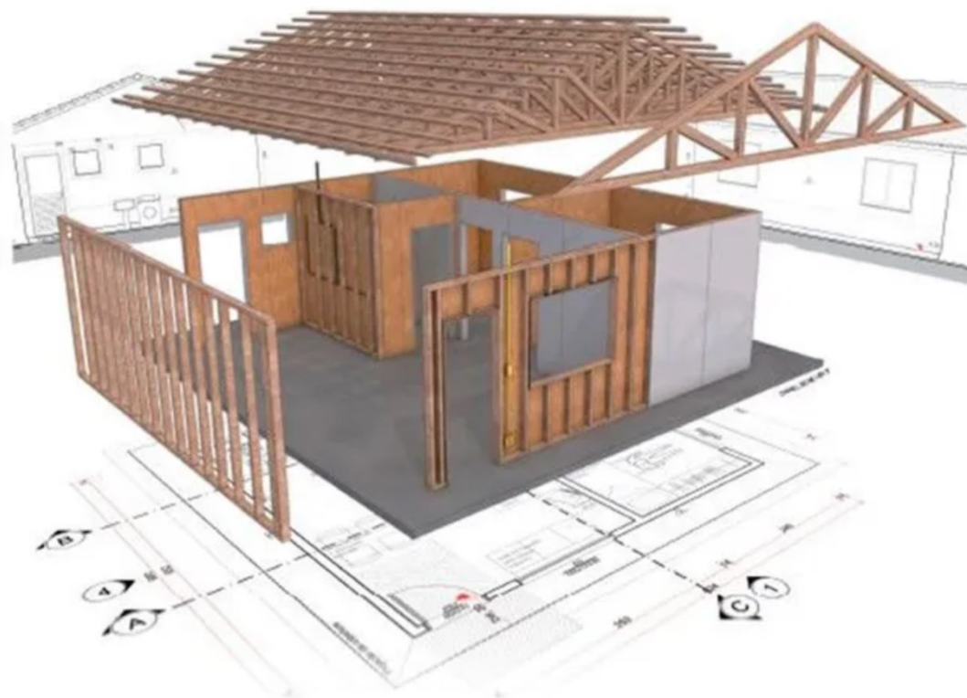
Figura 1 – Sistema Light Wood Frame
