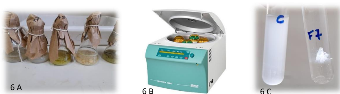
Figura 6. (6A) Fermentação em meio líquido com isolados fúngicos, (6B) Centrifugação das amostras, (6C) Precipitação do sobrenadante em etanol para detecção de produção de EPS.
