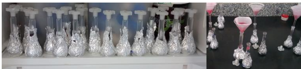
Figura 12. Armazenamento a 5°C (esquerda) e filtragem (direita) de amostras de flor de amor-perfeito ( V. wittrockiana ) preparadas para determinação de flavonoides e antocianinas totais
