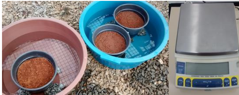
Figura 7. Vasos de monitoramento imersos em água para saturação do substrato (esquerda) e balança de precisão para posterior pesagem dos vasos (direita)
