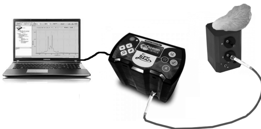
Figura 1. Equipamentos e acessórios usados para medir a reflectância espectral de folhas de alface.
