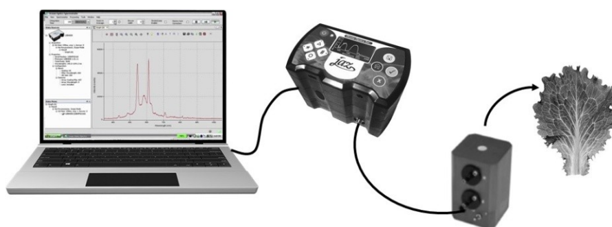
Figura 1. Equipamentos e acessórios usados para medir a reflectância espectral
