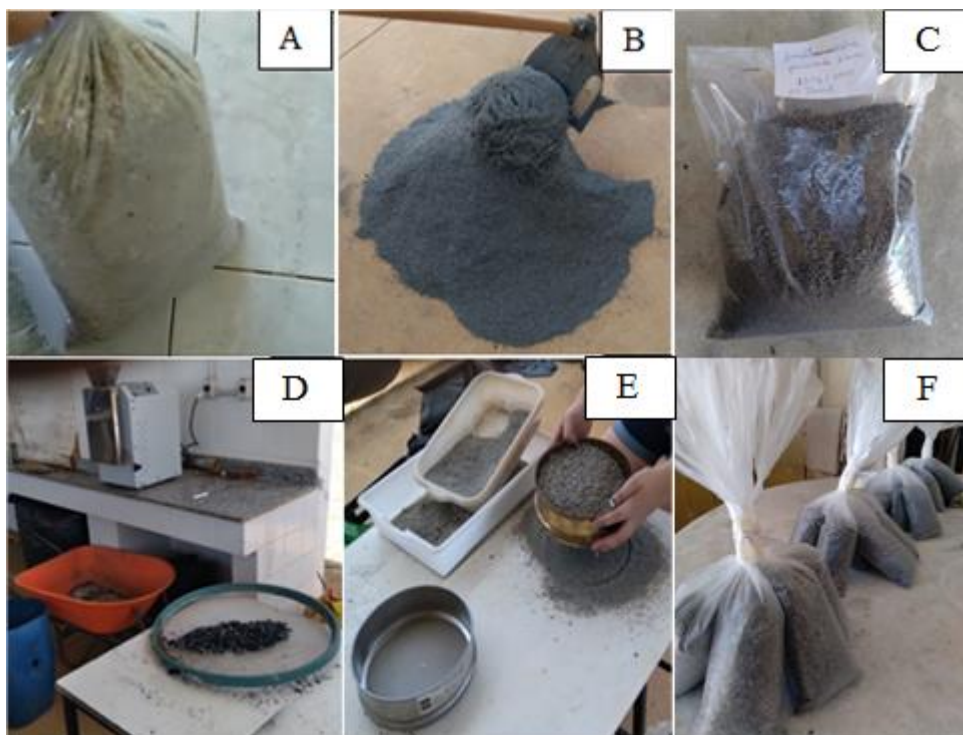
Figura 3. A) Escória bruta, retirada da siderúrgica B) Escória após secagem e seleção na peneira de 2 mm C) Porção de escória reservada para análises complementares D) Moinho de martelo e peneira grossa para retirada do excesso de carvão E) Retenção de partículas maiores que 2 mm. Escória pesada e separada nas suas devidas doses para ser aplicada na linha de plantio como tratamentos.
