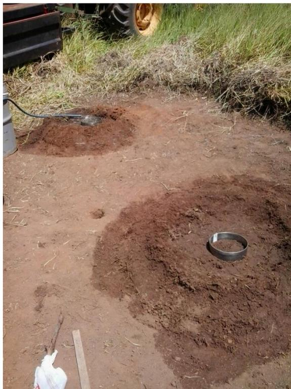
**Figura 28** - Infiltrômetros de anel instalados no campo para o teste de infiltração.
