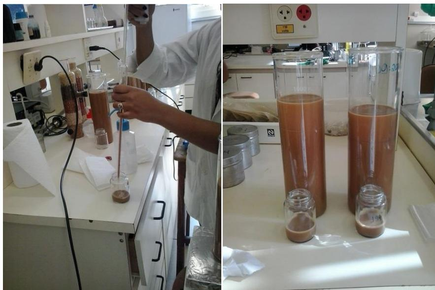
**Figura 27** - Detalhes do conteúdo pipetado sendo colocado no vidro (esquerda); e à direita é mostrado o cilindro de sedimentação com suspensão de silte+argila e vidros com material pipetado.
