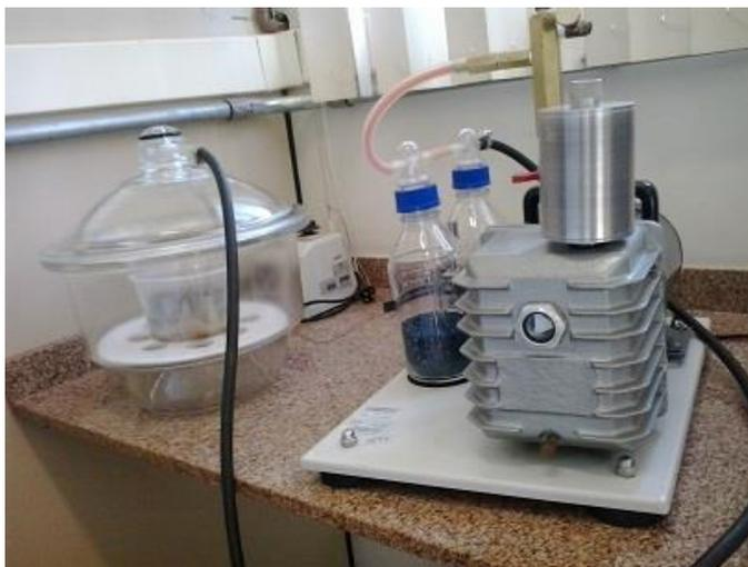
**Figura 18** - Aparelho de vácuo utilizado para completar a saturação das amostras.
