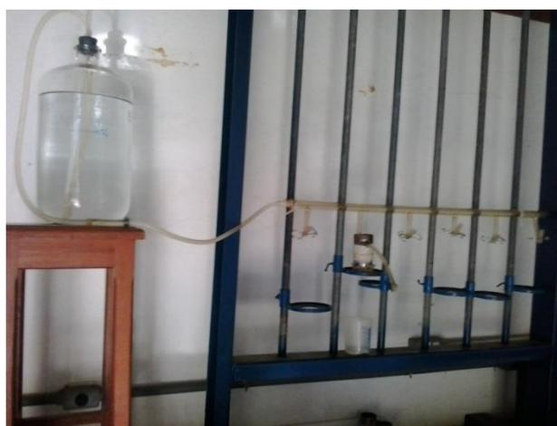
**Figura 29** - Detalhe do permeômetro de carga constante montado e com uma amostra de solo em teste.
