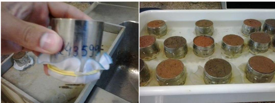
**Figura 17** - Detalhe do preparo e identificação das amostras (à esquerda); e a forma de saturação das amostras (à direita).
