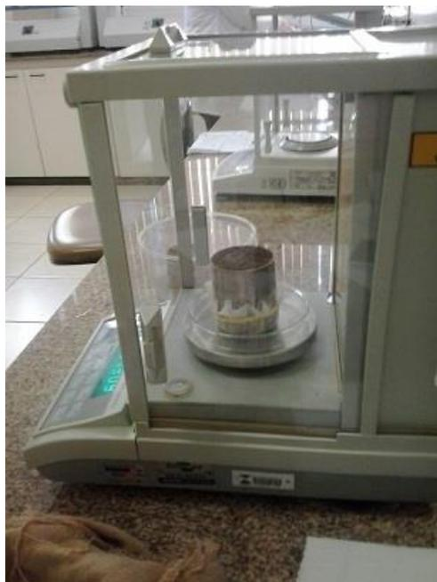
**Figura 21** - Detalhe da pesagem das amostras realizada a cada troca de tensão.
