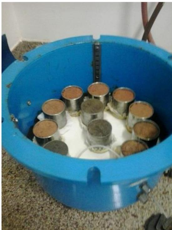
**Figura 22** - Amostras colocadas sobre a placa dentro do extrator.
