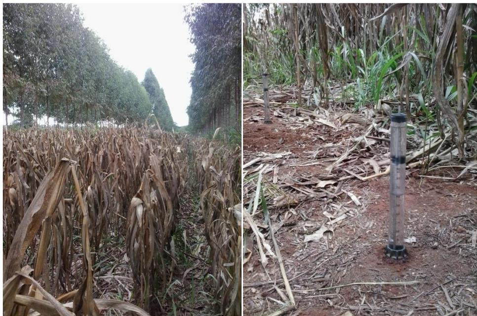
**Figura 11** - Detalha do mini-infiltrômetro instalado na área do ILPF nova.
