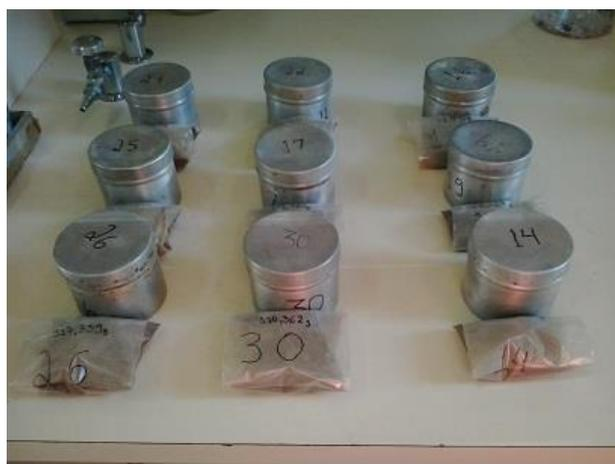
**Figura 23** - Amostras deformadas (saquinhos) após preparação e amostras indeformadas dentro das latas após receberem o tecido e a borracha.
