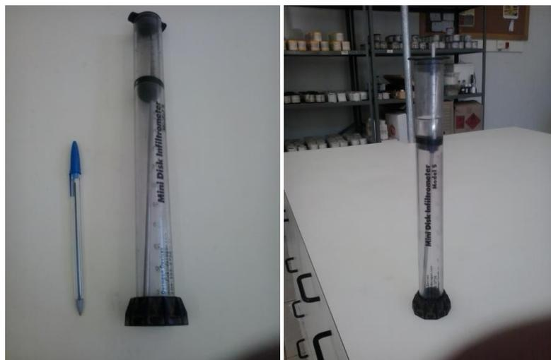
**Figura 12** - Infiltrômetro de disco modelo Decagon Devices, Inc.
