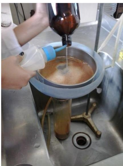
**Figura 26** - Detalhe da lavagem da areia após a retirada das garrafas âmbar do agitador.
