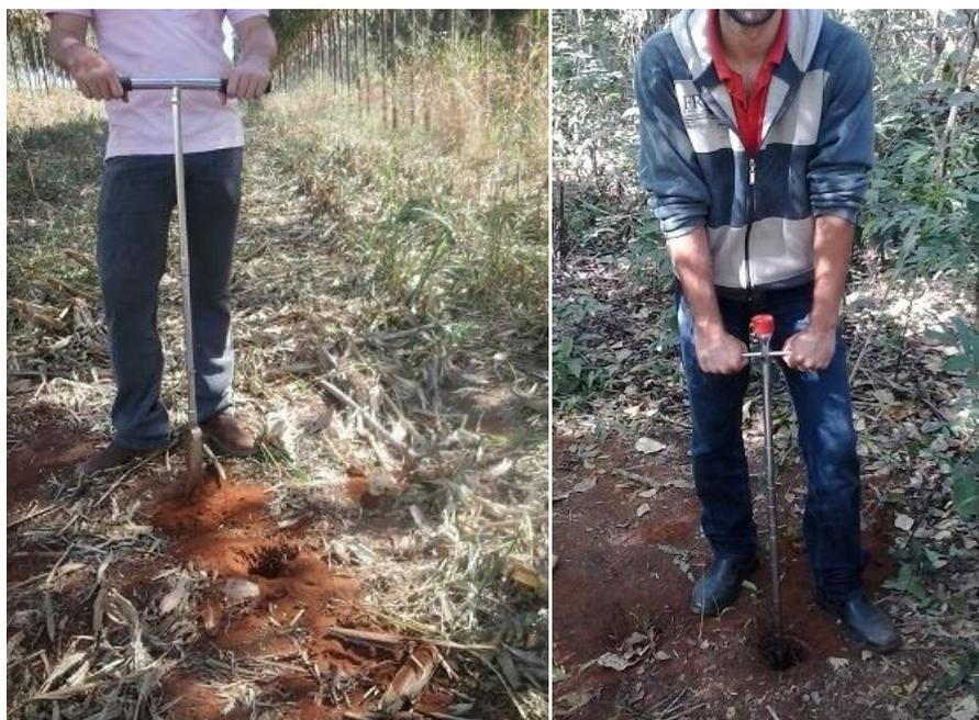
**Figura 15** - Detalhe da retirada de amostras de solo. Na esquerda, a retirada de amostra deformada com trado Holandês e, na direita, a retirada de amostra indeformada com trado específico para esse fim.
