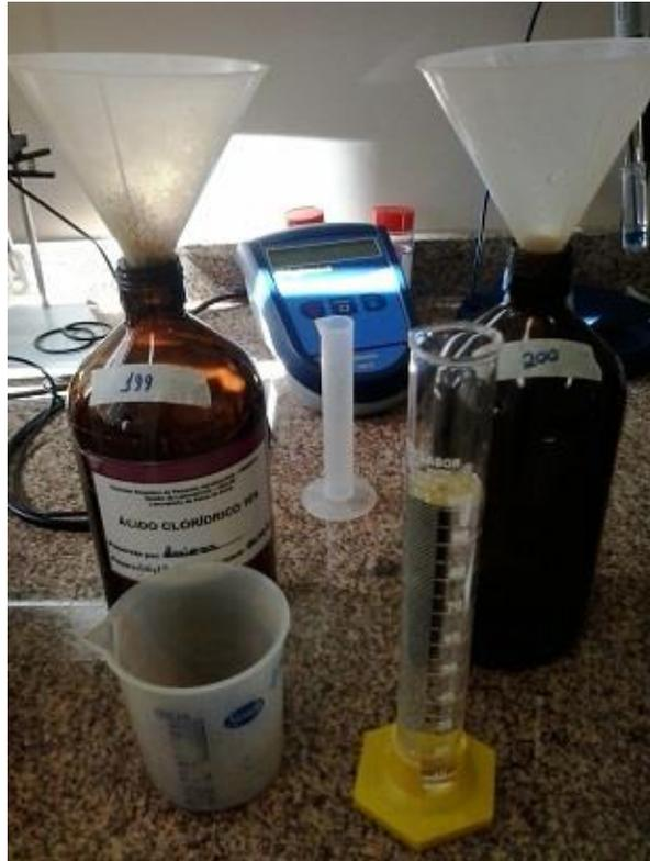
**Figura 24** - Detalhe da amostra de solo (béquer), da água deionizada (proveta) e do dispersante (proveta ao fundo) para a análise de granulometria.
