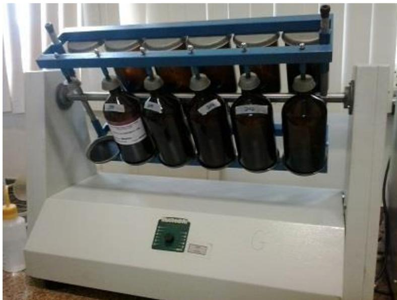
**Figura 25** - Agitador orbital tipo Wagner com as garrafas âmbar já acopladas.
