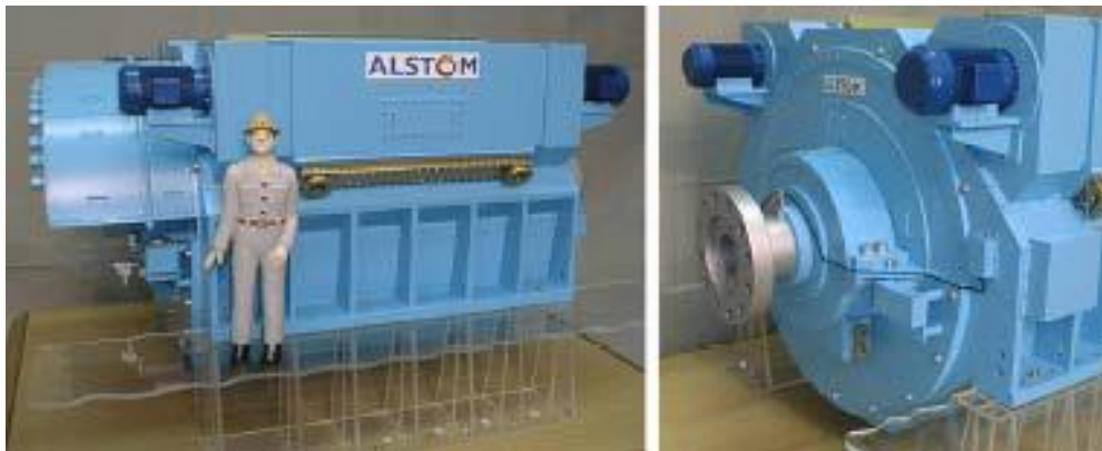
Figura 1.1 - Motor de Indução Avançado (AIM – Advanced Induction Motor) de 15 fases. Fonte: Extraído de [5].
