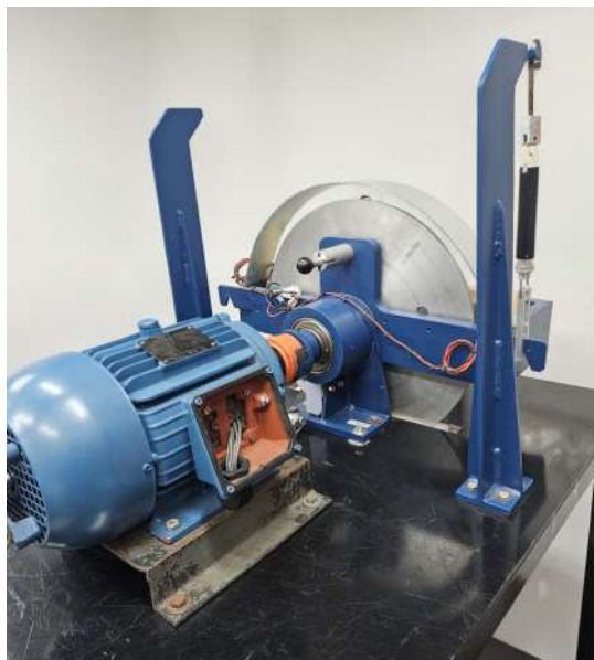
Figura 3.5 – Freio de Foucault empregado nos ensaios experimentais, possibilitando o ajuste controlado da força de frenagem aplicada ao eixo, de modo a simular diferentes condições de carregamento.
