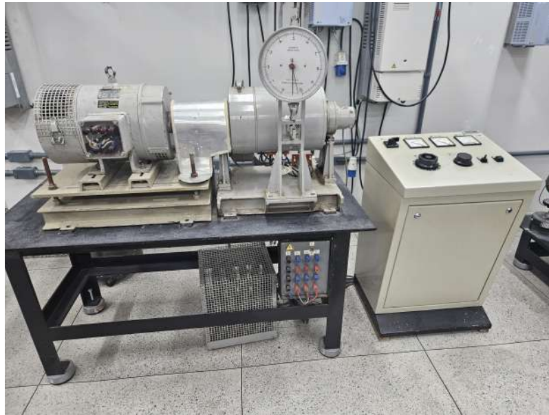
Figura 3.8 – Gerador síncrono acoplado a uma máquina de corrente contínua.
