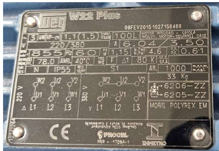
Figura 3.1 – Placa de identificação do motor da WEG de 1,5 cv utilizado nas análises deste trabalho.
