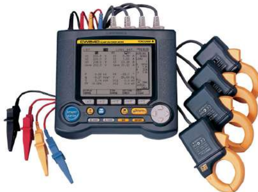
Figura 3.11 – Analisador de energia Yokogawa modelo CW240 utilizado nos ensaios com alimentação via inversor de frequência.
