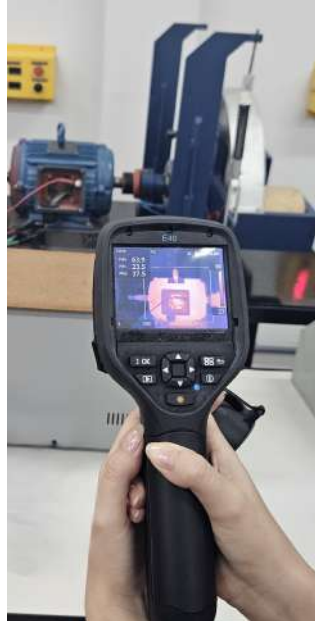
Figura 3.4 – Medição de temperatura da carcaça do motor com câmera termográfica.
