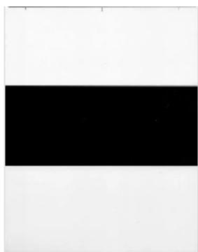
Figura 34 – Cartão de contraste para o teste do poder de cobertura da tinta úmida Foto: autor
