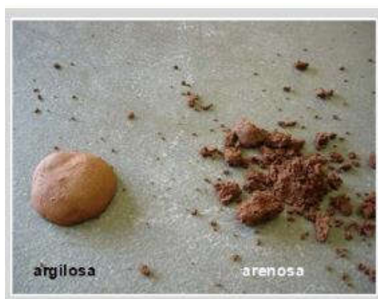
Figura 23 – Teste da queda da bola: aspectos do espalhamento, em função do tipo de solo (argilosa, à esquerda e arenosa à direita)
