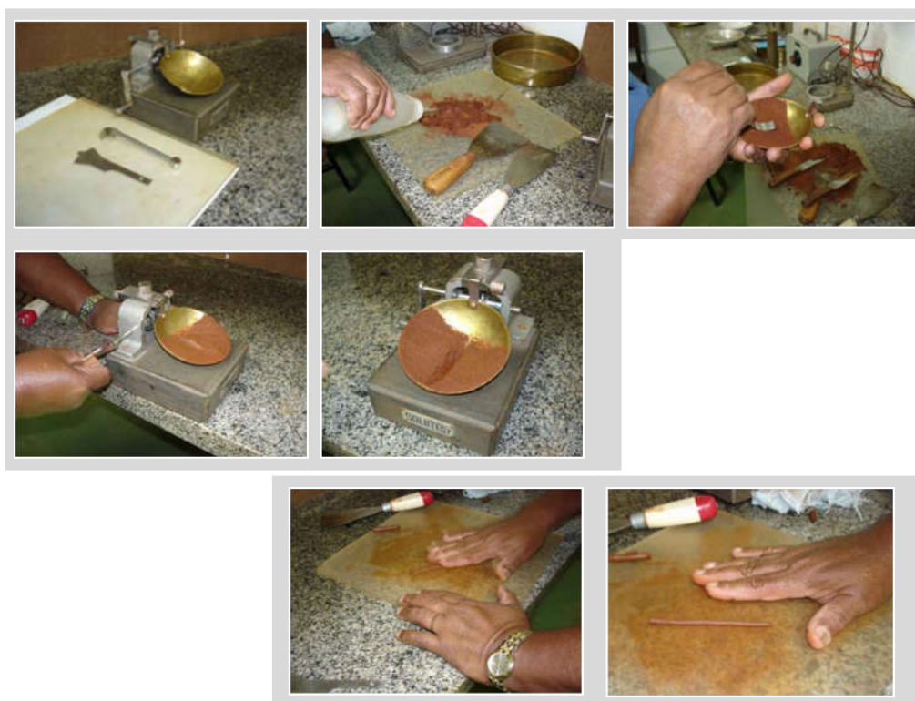
Figura 16 – Ensaio de determinação do limite de liquidez (LL), observando-se o aparelho de Casagrande, com seus acessórios e Ensaio de determinação do limite de plasticidade.
