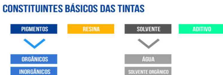
Figura 10 – Constituintes básicos das tintas
