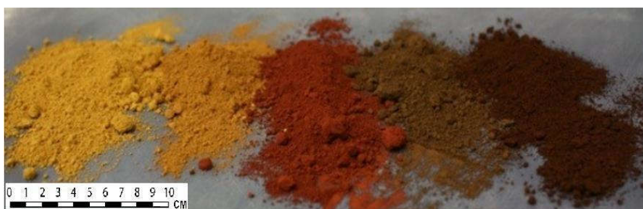
Figura 5 – Ocres, óxidos de ferro naturais Fonte Gomes et al. (2014)
