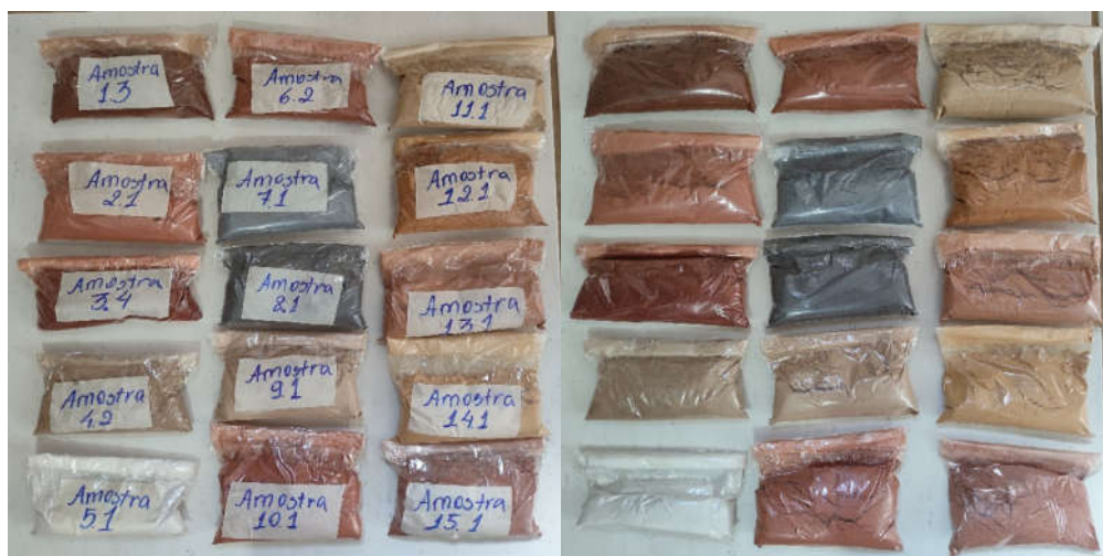
Figura 21 – Amostras dos solos selecionadas para o teste de granulometria (uma amostra de cada coleta realizada) - Fonte: autor
