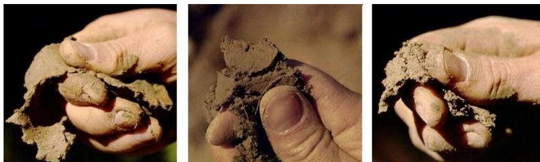
Figura 22 – Método para determinação da textura do solo Foto: Sheila R. Weil – Fonte: https://edisciplinas.usp.br/ (Apostila Arquitetura e propriedades físicas dos solos)
