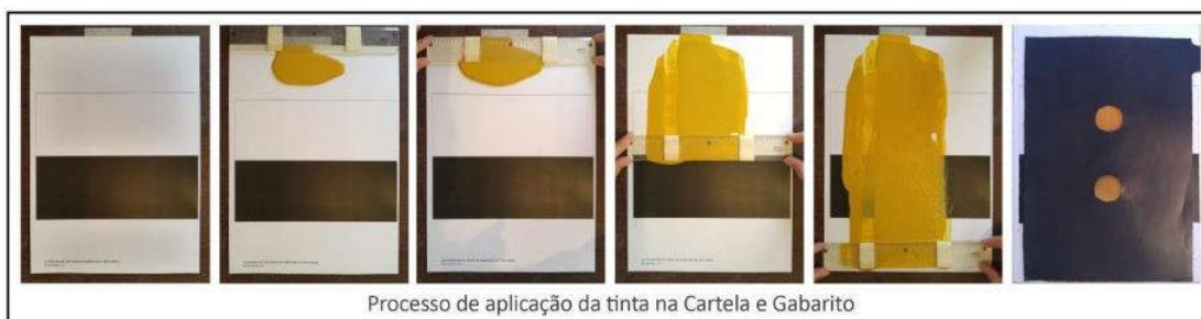
Figura 35 – Processo de aplicação da tinta para o teste do poder de cobertura da tinta úmida Fonte: Roberta Andrade, 2016 – Projeto de pesquisa: Saberes da Terra - Tons do Solos.
