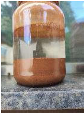
Figura 24 – Teste do vidro de sedimentação Foto: autor
