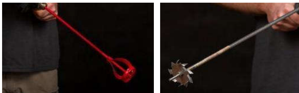
Figura 17 – Misturador de tinta helicoidal e dispersor Cowles adaptados à furadeira Fonte: Cartilha eletrônica “Cores da Terra – produção de tintas com pigmentos de solos” (Carvalho et al. , 2021)
