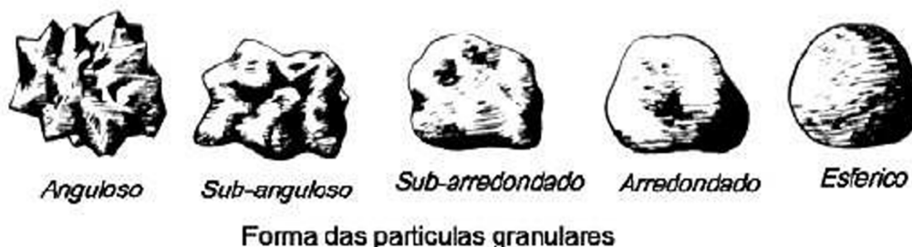
Figura 14 – Formas das partículas granulares
