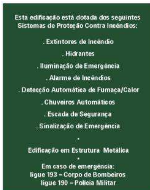
Figura 10 – Sinalização tipo M1
