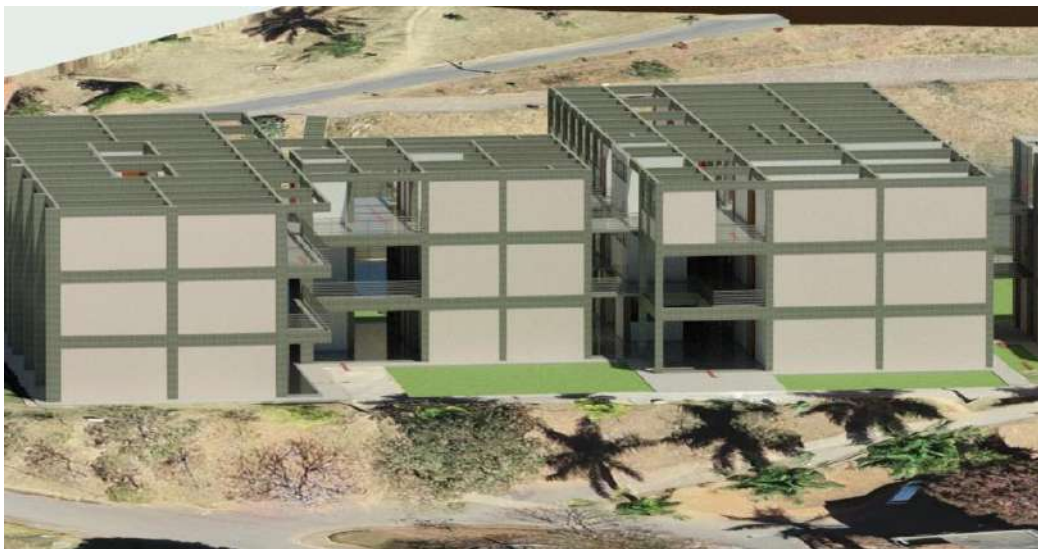
Figura 44 - Imagem dos prédios obtida com a junção dos pontos obtidos com o Laser scanner GeoSLAM ZEB REVO e com o aerolevanteamento
