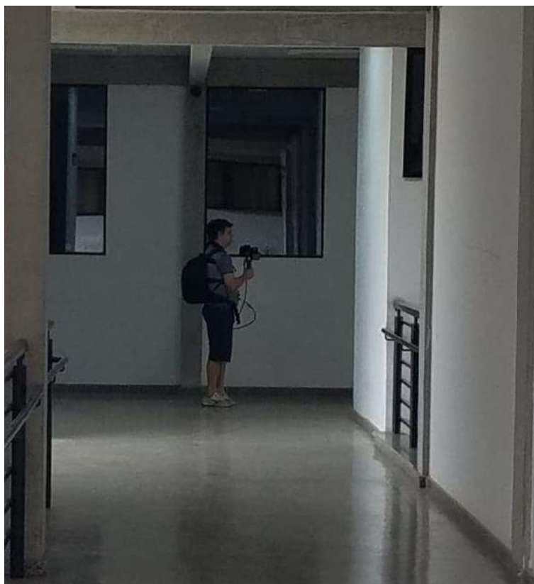
Fotografia 4 - Captura de imagens internas com laser scanner GeoSLAM ZEB REVO
