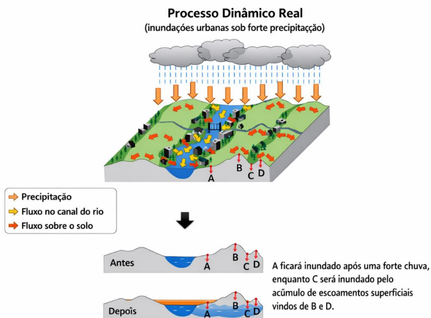
Figura 2: Representação esquemática dos processos de chuva-escoamento/inundações em áreas urbanas.
