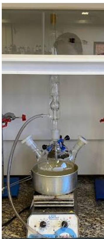
Figura 10- Sistema de aquecimento em refluxo
