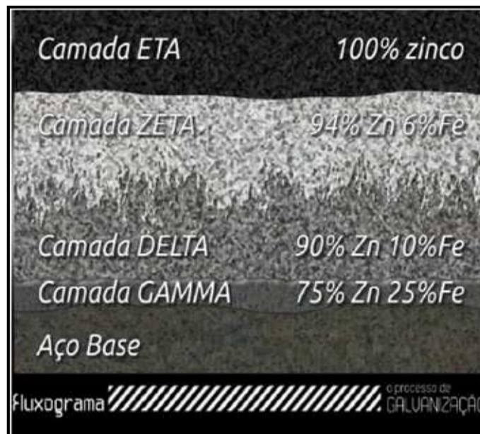
Figura 8 – Proteção por Barreira.
