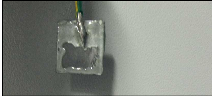
Figura 12 – Amostra da Chapa de Aço Galvanizado com a inserção do revestimento
