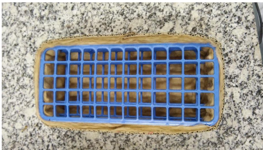
Figura 2. Porta tubo revestido de lã de vidro.
