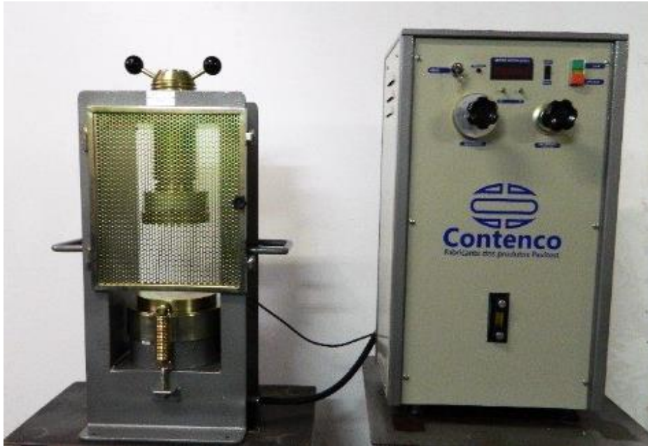
Figura 16 – Foto ilustrativa da prensa eletro-hidráulica para ensaios de resistência à compressão
