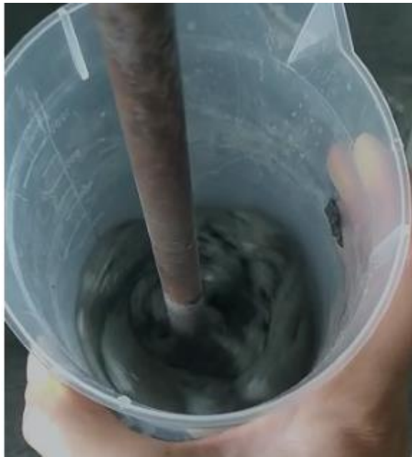
Figura 14 – Foto ilustrativa da preparação da homogeneização das pastas geopoliméricas
