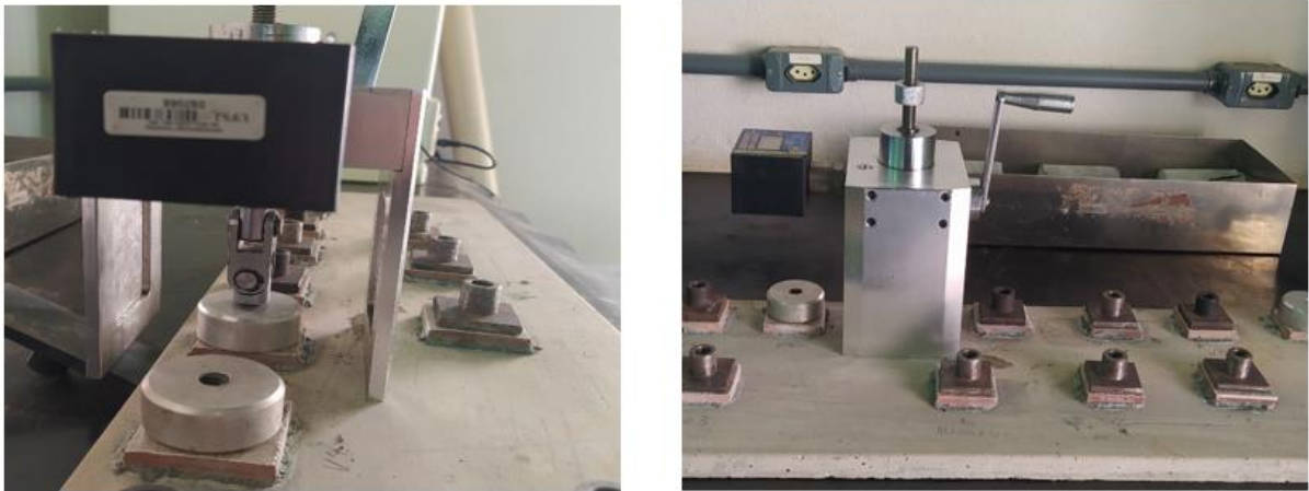
Figura 19 - Ensaio de resistência de aderência à tração (arrancamento) dos geopolímeros produzidos
