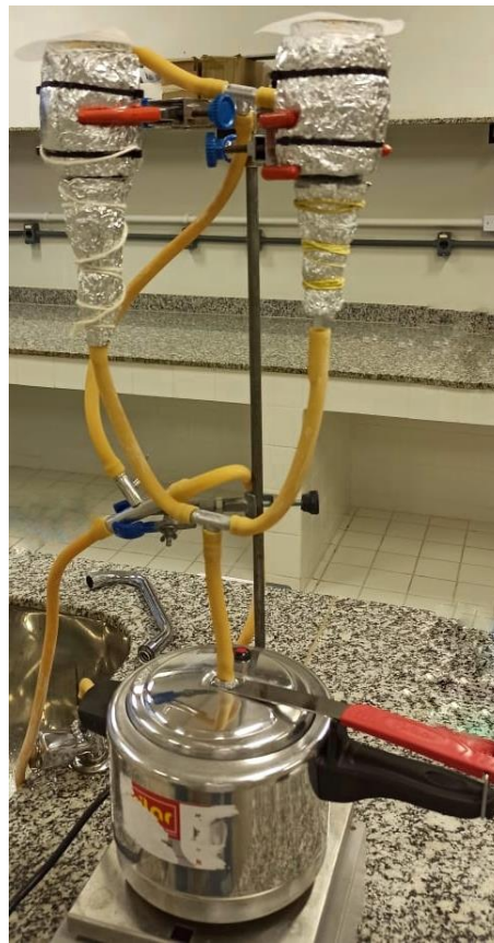
Figura 16: Esquema do banho de vapor utilizando funis para suporte do carvão.
