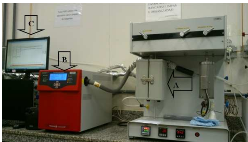
Figura 9: Aparato experimental utilizado na realização dos testes catalíticos. Em A, temos o forno e o aparato instrumental utilizado no controle do aquecimento do reator; em B, temos o espectrômetro de massas e, em C temos um computador para leitura dos dados.
