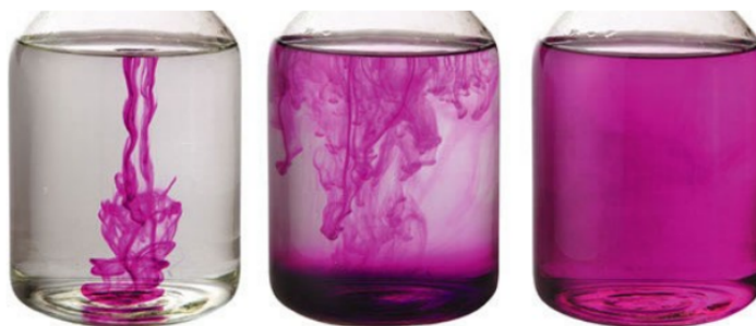
Figura 1.5: Gotas de corante diluído em água; no começo o corante ocupa uma pequena região que se espalha de forma homogênea
