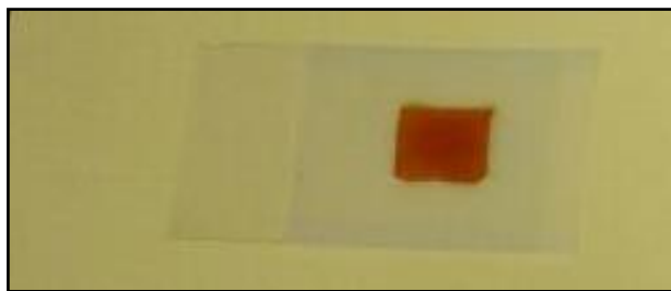
Figura 16. Eletrodo de PET/ITO/V 2 O 5 preparado no presente estudo
