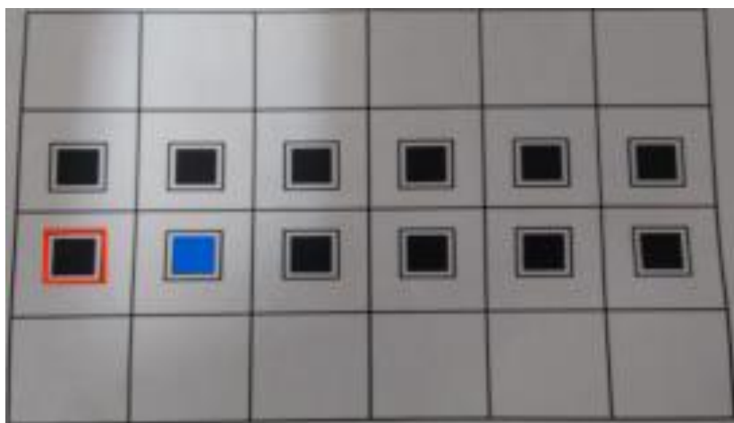
Figura 7. Molde utilizado para deposição das pastas de TiO 2 .
