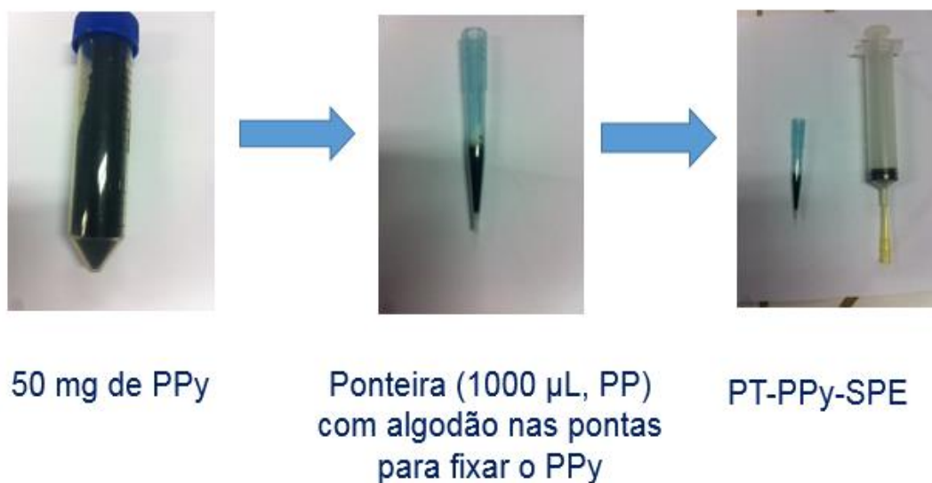
Figura 4.4. Dispositivo in-lab para preparo de amostras por PT-PPy-SPE Fonte: próprio autor
