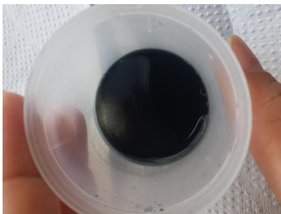
Figura 15 - Aparência do VO 2 sintetizado pela via hidrotérmica. Fonte: próprio autor.
